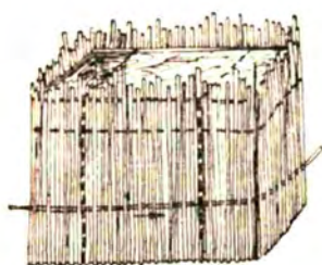
a- Inicialización de las paredes (las líneas de puntos indican los hilos de sujeción)
